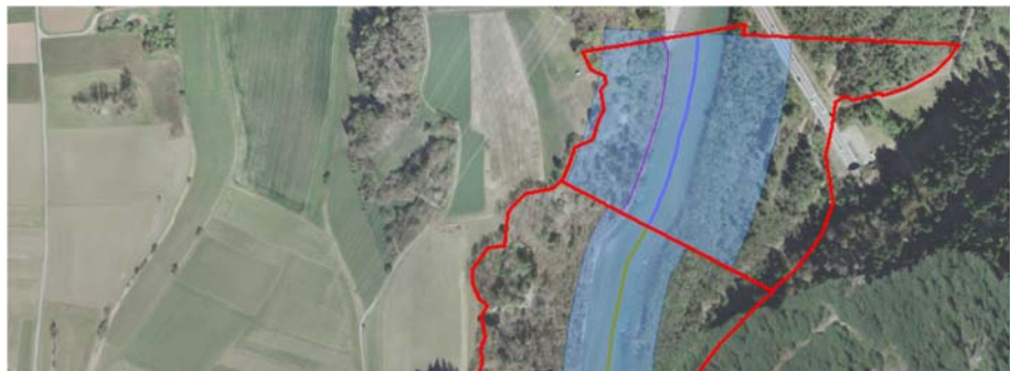
Bild 4: Laterale Verschiebung oberhalb der Isla Bella Brücke mit Unterkante Flussebene (violett), zentrischem (hellblau) und definitivem Gewässerraum (rot).
