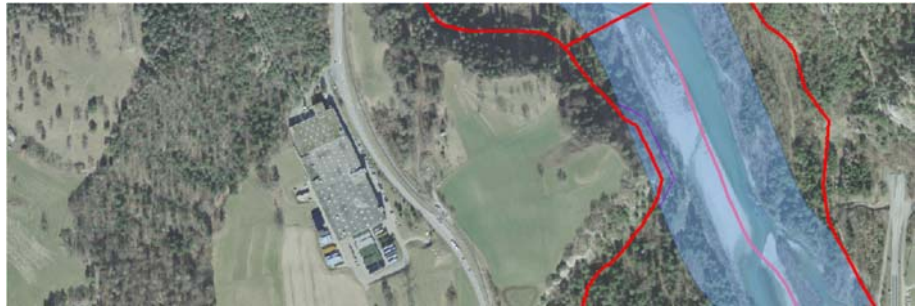
Bild 3: Laterale Verschiebung östlich der Mineralquelle mit Unterkante Flussebene (violett), zentrischem (hellblau) und definitivem Gewässerraum (rot).
