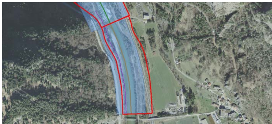
Bild 2: Laterale Verschiebung unterhalb der Fussgängerbrücke nach Rothenbrunnen mit Sohlkante (violett), zentrischem (hellblau) und definitivem Gewässerraum (rot).
